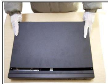
2. ábra Tető leemelése
