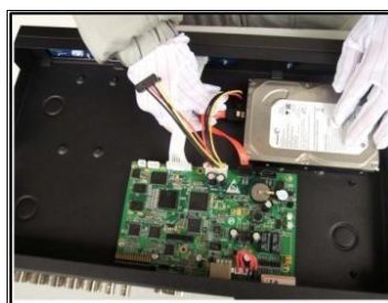
4. ábra HDD rögzítése
