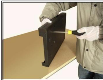
3. ábra HDD becsavazása
